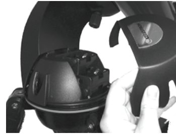
Abnehmen des Batteriefachdeckels
