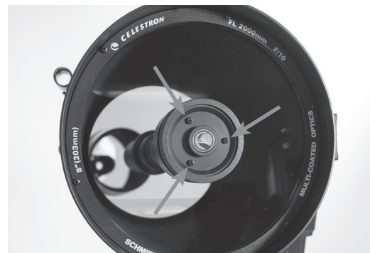
Tornillos de ajuste de colimación del espejo secundario
