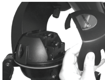
Extracción de la tapa del compartimiento de baterías.
