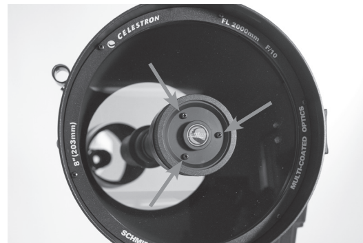
Vis d'ajustement de collimation du miroir secondaire
