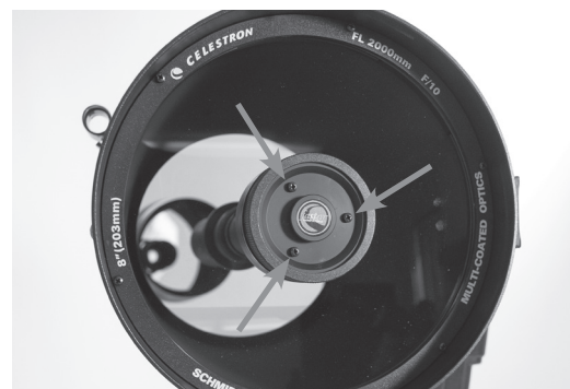
Kollimations-Justageschrauben für den Sekundärspiegel
