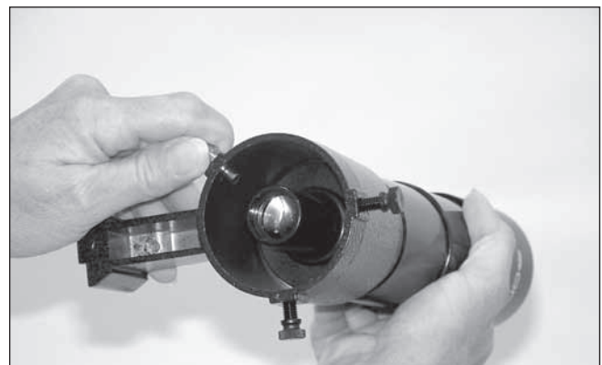
Figura 3b. Tirare il perno regolatore di tensione e fare scorrere il cercatore sul supporto finché l'O-ring non si incastra nel relativo alloggiamento sul supporto.
