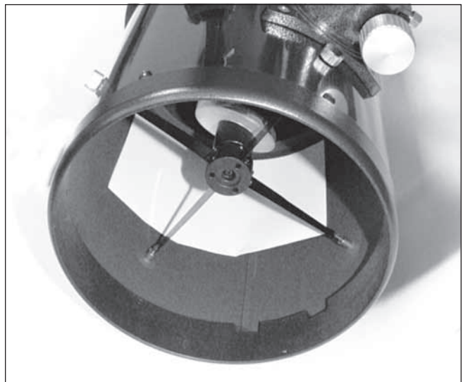
Figura 10. L'inserimento di un pezzo di carta bianca nel tubo ottico di fronte al focheggiatore fornisce uno sfondo luminoso quando si guarda nel focheggiatore.
