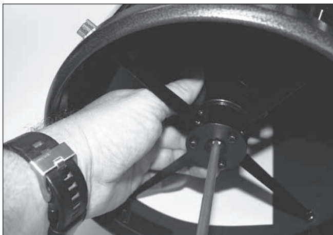
Figura 11. Per centrare lo specchio secondario assialmente sotto il foccheggiatore, mantenere in posizione il supporto dello specchio secondario con le dita mentre si regola la vite centrale con un grande cacciavite a croce. Più avanti verrà regolata l'inclinazione dello specchio secondario girando le tre piccole viti intorno alla grande vite centrale.
